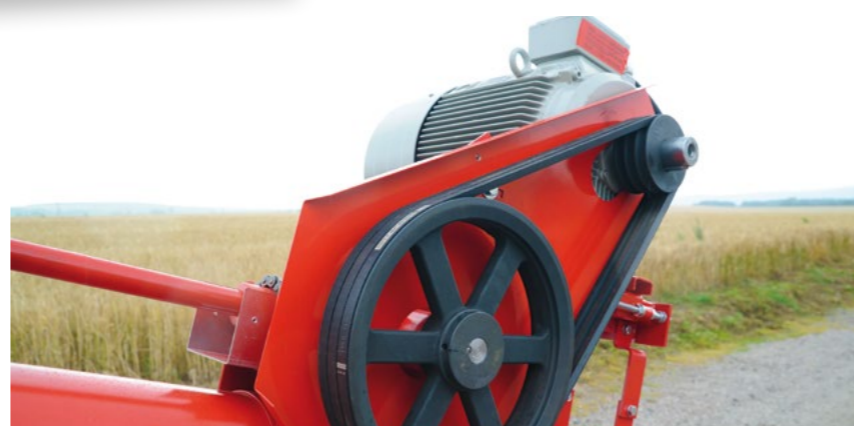
ременные шкивы больших размеров для оптимальной передачи усилий
